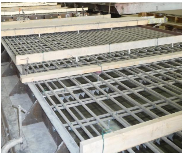
Obr. P3-1: Příklady kompozitní výztuže (zdroj: ACI 440.1R a https://www.tuf-bar.com )
